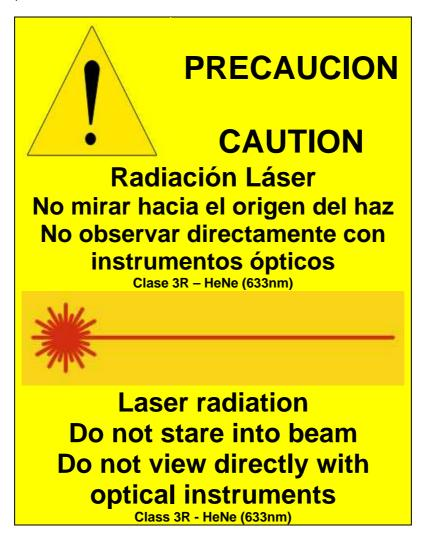
Por ejemplo: para un láser Clase 3R de un tipo concreto (faltaría especificar la potencia):
