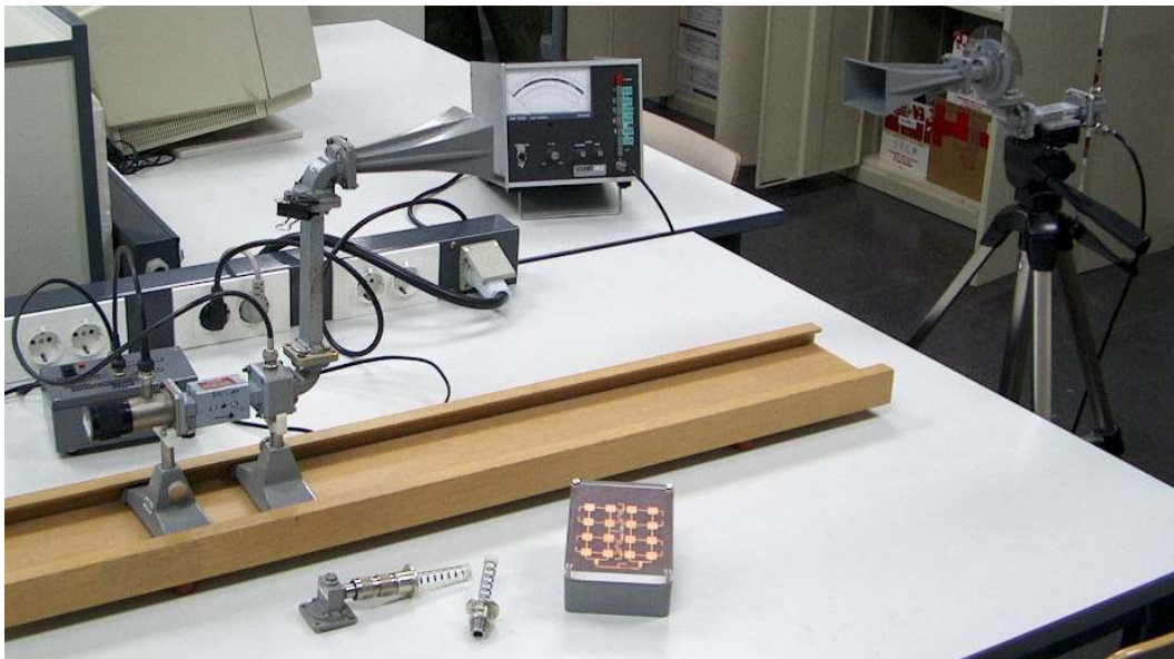
Figura 1. Montaje para realizar medidas de polarización de antenas
