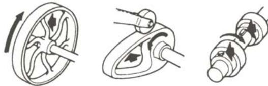
c) Herramientas de corte y abrasión: Entran en contacto con el material para alterar su forma, tamaño o acabado (herramientas de corte, muelas abrasivas, etc.)
