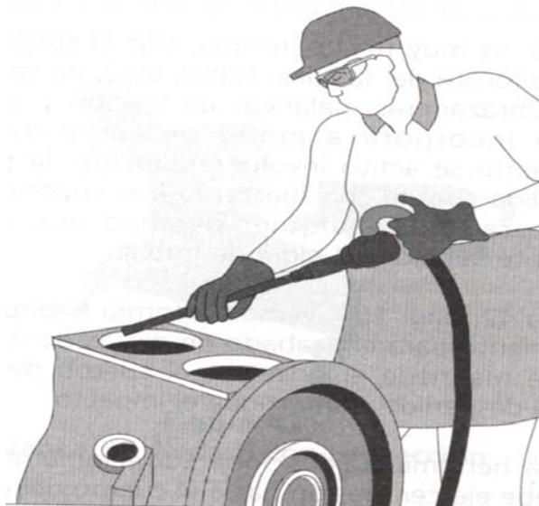
Fig. 1.- Empleo del martillo neumático con cabeza de cincel
