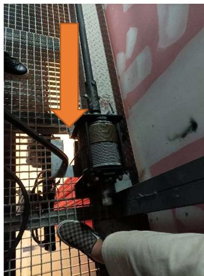
Cuando el rotor entra en funcionamiento, las mangueras de iluminación de los focos, bajan junto a un cable de acero por el hueco que existe en el suelo junto al rotor. Los huecos donde se deslizan las mangueras carecen de resguardos de protección.
