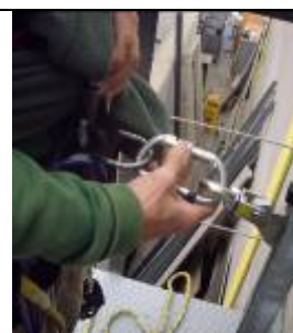
Figura 21 – Desconexión del dispositivo anticaídas deslizante
