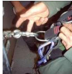
Figura 6.- Anclaje al dispositivo anticaídas deslizante
