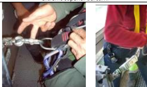
Figura 17.- Anclarse al dispositivo anticaídas deslizante
