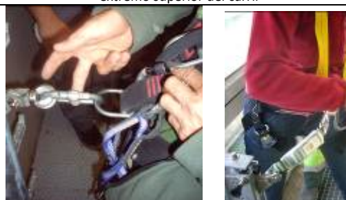
Figura 17.- Anclarse al dispositivo anticaídas deslizante
