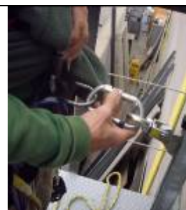
Figura 21.- Desconexión del dispositivo anticaídas deslizante
