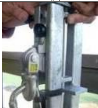
Figuras 10, 11 y 12- Giro de la parte m3vil y extracci3n del carro del carril
