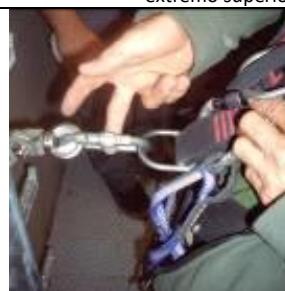
Figura 17.- Anclarse al dispositivo anticaídas deslizante
