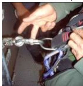
Figura 17.- Anclarse al dispositivo anticaídas deslizante
