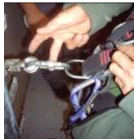
Figura 6.- Anclaje al dispositivo anticaídas deslizante
