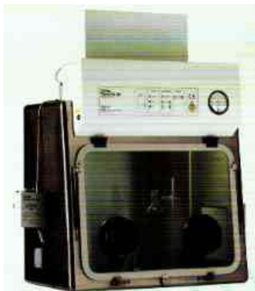
Figura 5. Cabina de seguridad microbiológica de clase III
